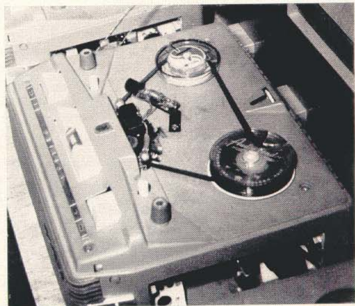
Abb. 3 Ein Tonbandgerät mit Endlos-Kassette und Lichtschranke, die am linken, schräg laufenden Tonbandstück erkennbar ist.
