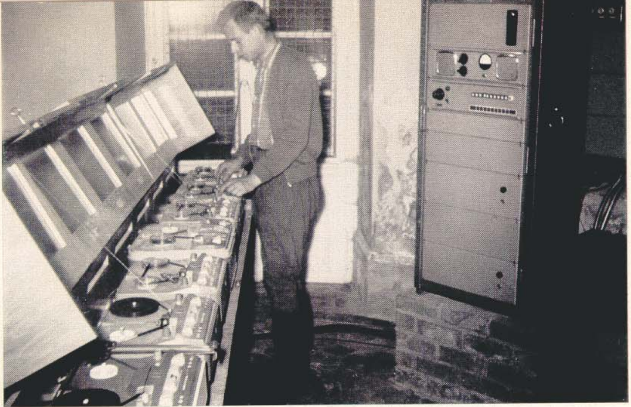
Abb. 2 Die technische Zentrale besteht aus einem Gestellverstärker und sieben speziell eingerichteten Tonbandgeräten. Als Tierpfleger weiß Herr Lippert selbstverständlich mit den Tauben des Aschenputtel und den anderen lebendigen Tieren der Gartenschau umzugehen. Nicht weniger gut versteht er sich aber auch auf den Umgang mit seinen „lebenden Märchentieren“ und ihrem technischen Herzen.
